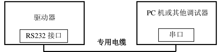
图 6 参数调试接线原理图
