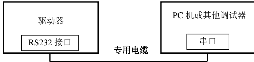
图 6 参数调试接线原理图
