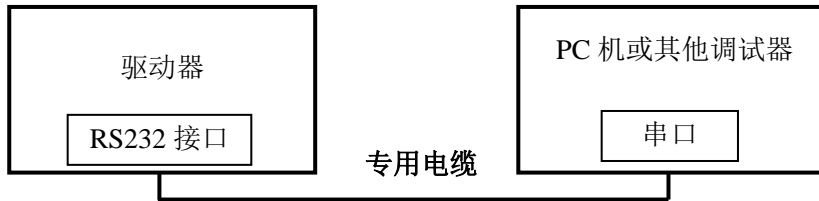
图 6 参数调试接线原理图
