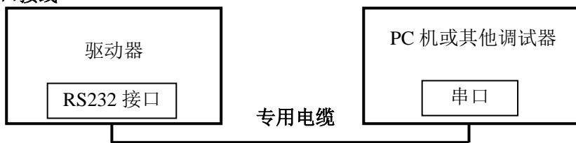
图 6 参数调试接线原理图
