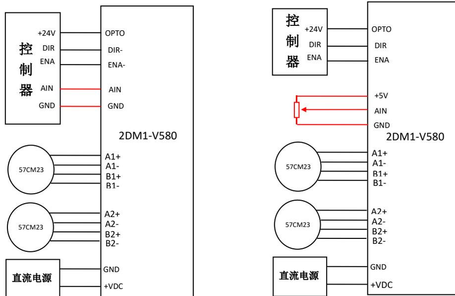
图 3-1 2DM1-V580 电气接线原理图
