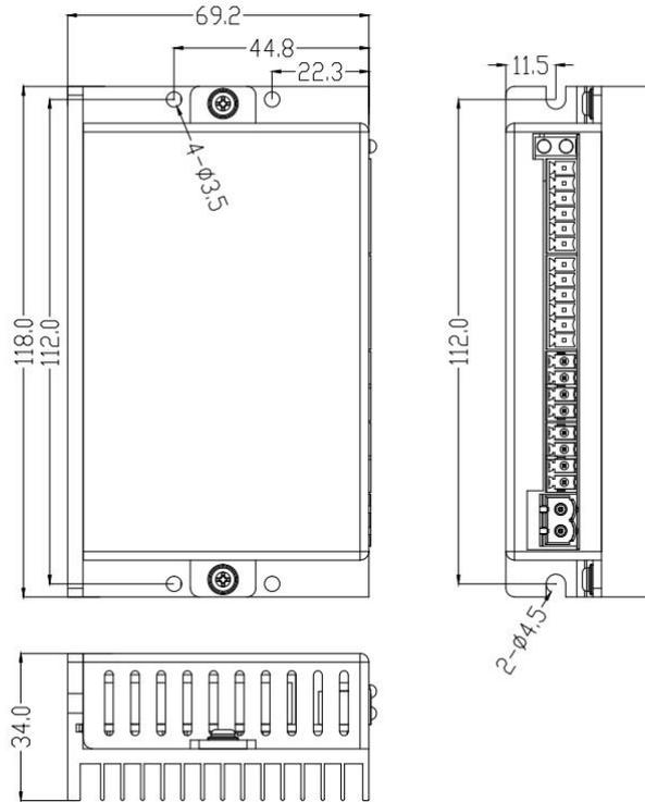
图 5-1 2DM1-V580 安装尺寸图
